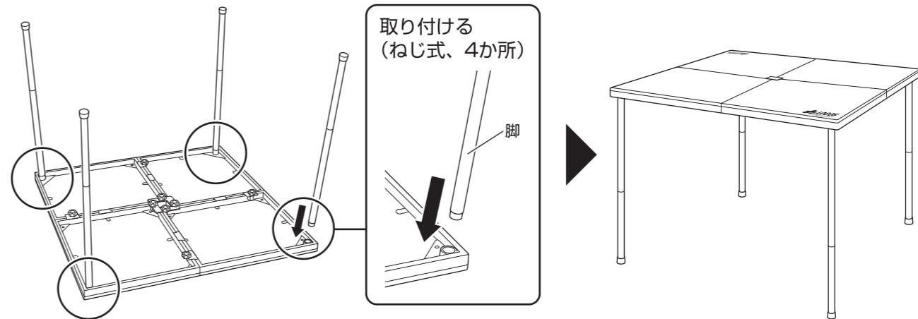
\*製品の構造上、脚の先は装着部に比べて外側に少し開いています。垂直ではなく、少し傾けながら取り付けてください。
