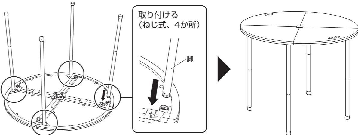
\*製品の構造上、脚の先は装着部に比べて外側に少し開いています。垂直ではなく、少し傾けながら取り付けてください。
