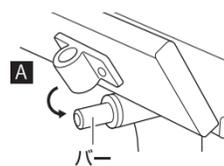
③反対側のバーの先端に留め具Bを確実にはめる
