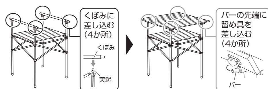
**4 BフレームとCフレームを風防のスリーブに差し込む**
