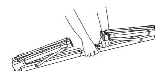
フレーム同士が接触して開きにくい場所の位置でフレームをつかみます。合は、手で接触部を外してください。
