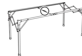
脚フレームを裏返したら、ベルトを連結します。
