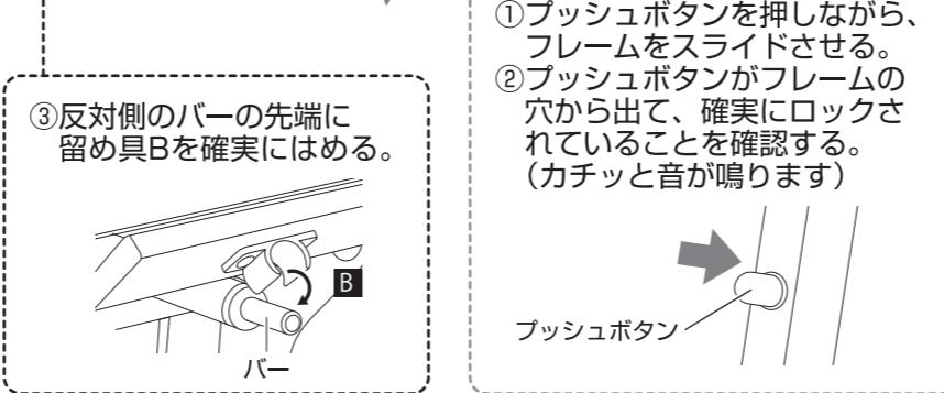
③反対側のバーの先端に留め具Bを確実にはめる。
