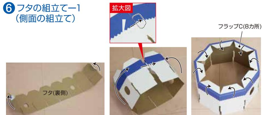
⑥フタを裏側が上になるように置き、①と同様の手順で組立てます。次に、フラップC(8カ所)を内側に折り曲げます。
