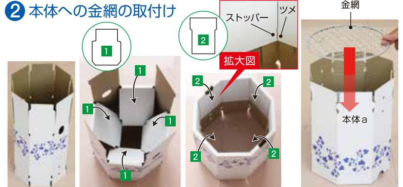
②本体aを図のように置き換え、1→2の順にフラップを内側に折り曲げ、ストッパーで固定します(8カ所)。次に、本体aを図のように置き換え、金網をセットします。
