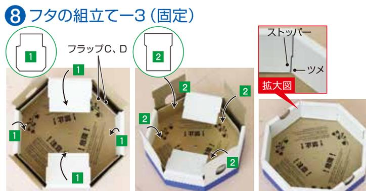
⑧フタを図のように置き換え、フラップC、Dを挟み込むように1→2の順に折り曲げ、ストッパーで固定します(8カ所)。
